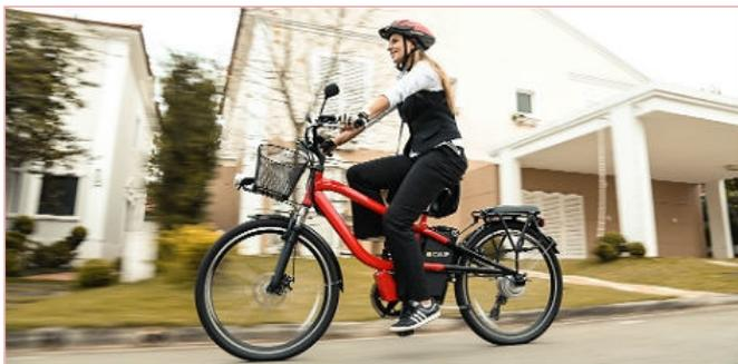
A DBL (foto) usa bateria em lítio, quadro de alumínio, freio a disco na roda da frente e suspensão dianteira
